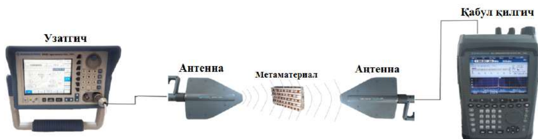
7 - расм. Метаматериалнинг антенна-фидер қурилмасига нисбатан самаралилигини аниқлаш учун йиғилган тажриба қурилма мажмуаси.
