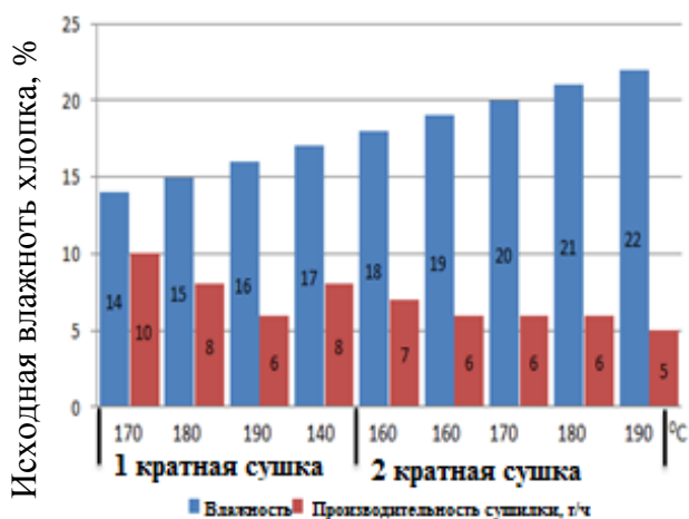
Рис.22. Режим работы сушилок 2СБ-10 и СБО в сушильно-очистительном цехе при сушке I-II сортов хлопка в зависимости от их исходной влажности.
