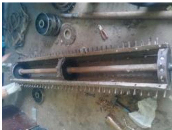
Рис. 7. Внешний вид рыхлительных барабанов с гибким элементом из эластичных материалов.
