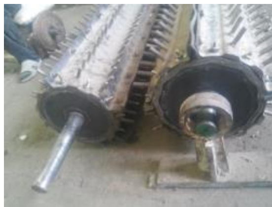
Рис. 7. Внешний вид рыхлительных барабанов с гибким элементом из эластичных материалов.
