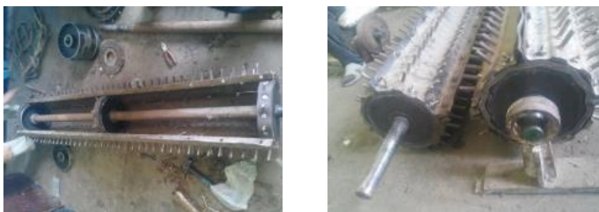
7-расм. Қайишқоқ элементли эластик материалдан тайёрланган титиш қозикчали барабан кўриниши.
