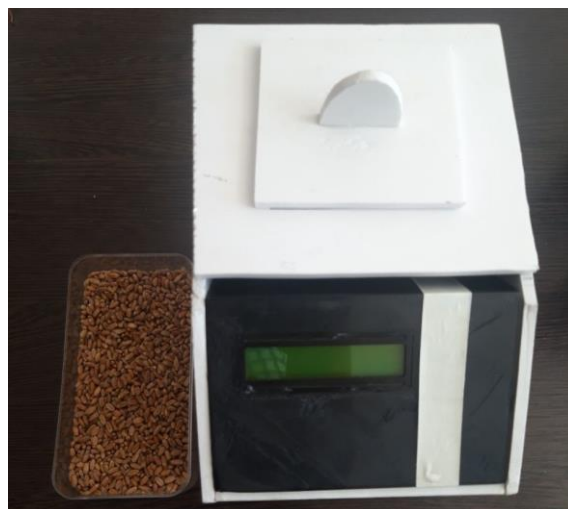
12-расм. Дон ва дон маҳсулотларининг намлигини сиғимли ўлчаш асбоби
