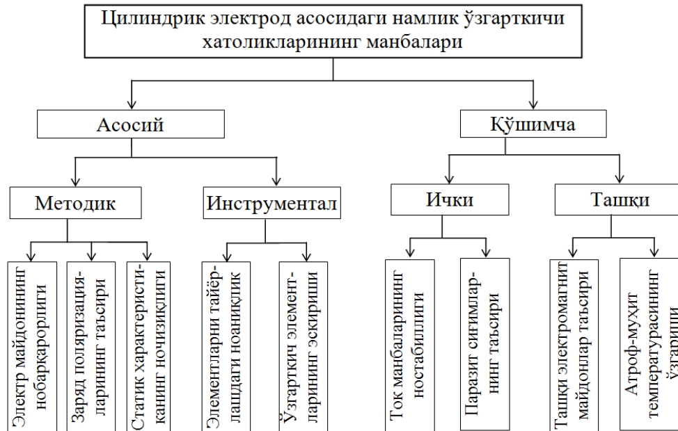
10-расм. Цилиндрик электрод асосидаги ўзгарткич хатоликлари манбаларининг классификацион схемаси
