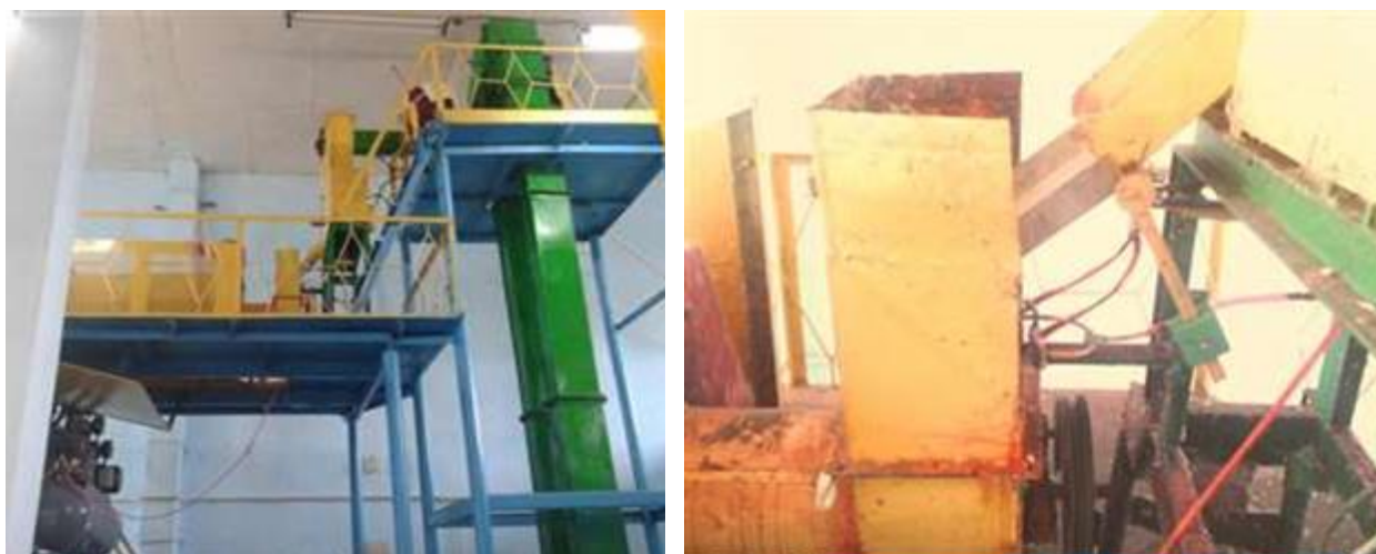
Рис.10. Проведение производственных исследований экспериментального образца протравливателя посевных семян
