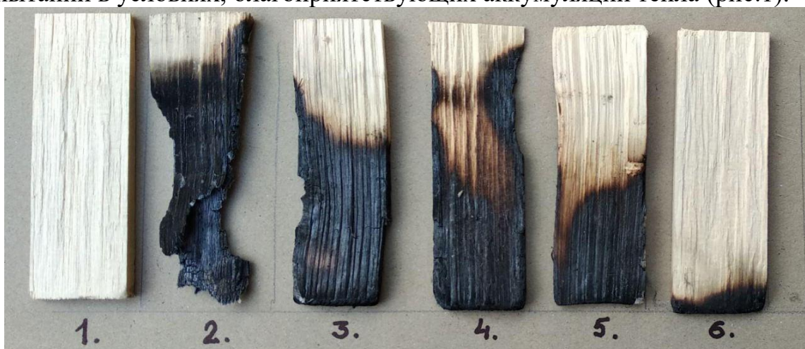
Рис. 1. 1-исходный образец древесины, 2-образец неогнезащищенной древесины после огневых испытаний, 3-древесина обработанная 3%-ным раствором промышленного антипирена-аммофос, 4-древесина обработанная 1%-ным раствором полимерного огнезащитного состава, 5-древесина обработанная 3%-ным раствором полимерного огнезащитного состава, 6-древесина обработанная 5%-ным раствором полимерного огнезащитного состава.
