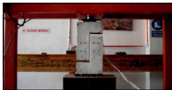
Рис. 9. Экспериментальная установка для испытания образцов-дисков при срезе
