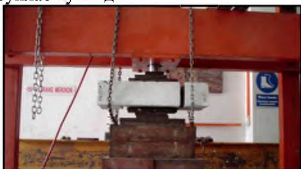
8–расм. Кесилиш текислиги бўйича чизикли ёрувчи юк берилган махсус қурилма
