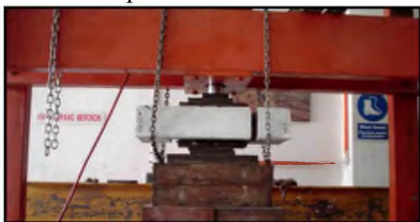
Рис. 8. Специальный образец, подвергнутый линейной раскалывающей нагрузке по плоскости среза
