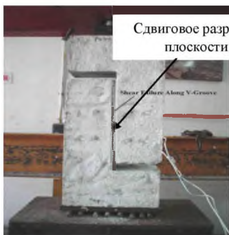
Рис. 10. Разрушение по плоскости среза неусиленного образца P1
