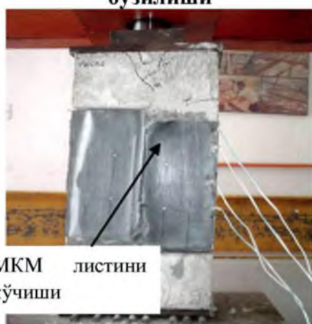
12–расм. МКМ ёрдамида ташқи арматураланган махсус PF3 намуна бетони сиртидан МКМ листини қатламлаб кўчиши (олд томони)
