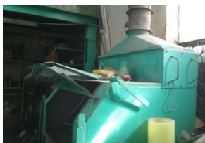
5-расм. Тажрибавий (корхонаники) абразив оқим камераси ва уларнинг техник характеристикалари:
