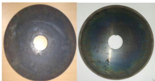
а) – ишлов берилмаган (корхонаники); б) – абразив зарралар оқимида ишлов берилган
