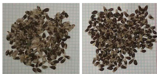
а) – корхона аррали дискларини линтерлаши; б) – тишларига абразив оқимли ишлов берилгандан кейинги аррали дискларини линтерлаши 17-расм. Линтерлаш жараёнини тажрибавий текширишини таққослашда кўринишини баҳолаш
