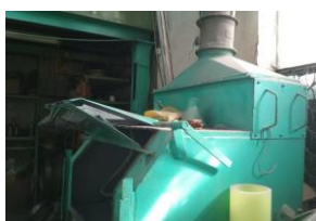
Рис.5. Экспериментальная (заводская) абразиво-струйная камера и ее
