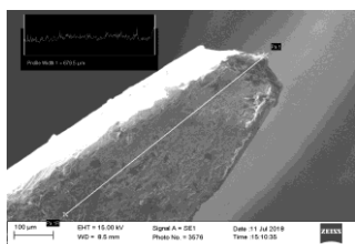
12-расм. Рентгенли дифракция микроскопияси методида сканерланган линтер арралари тишини чўққисининг микропрофили
