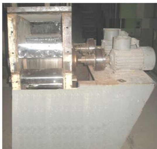
Расм.3. икки барабанли тўғри оқимли тола тозалагич стенд ўрнатмасининг умумий кўриниши.
