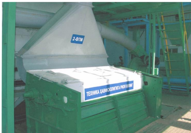
Рис. 6. Общий вид двухступенчатого прямооточного волокноочистителя марки 2-ВПМ
