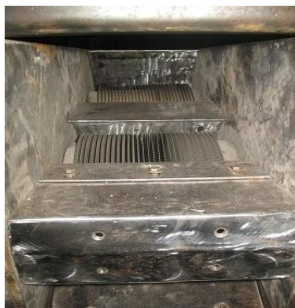
Рис. 4. Внутренний вид стенда двухбарабанного прямоточного волокноочистителя
