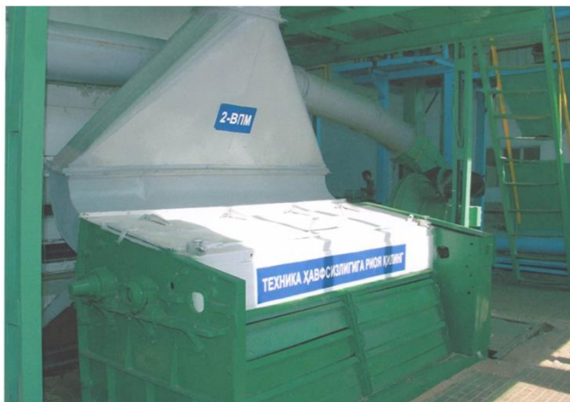
Расм.6. икки босқичли тўғри оқимли 2ВЛМ тола тозалагичнинг умумий кўриниши.
