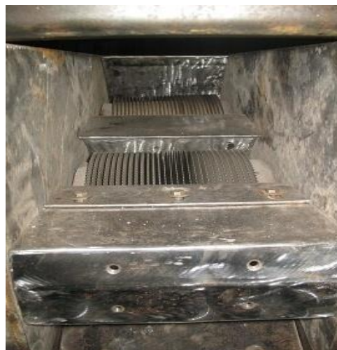
Расм.4. икки барабанли тўғри оқимли тола тозалагич стендининг ички кўриниши.
