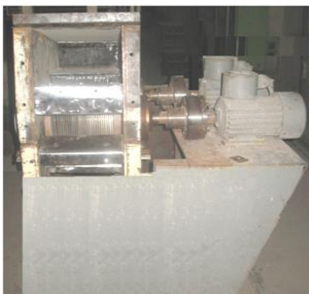
Рис. 3. Общий вид стенда двухбарабанного прямоточного волокноочистителя
