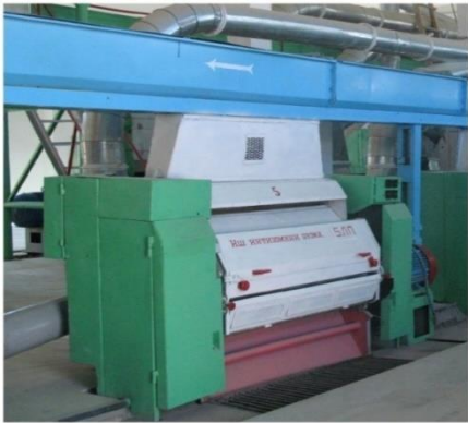
Рис.9. Общий вид линтера 5ЛП с усовершенствованными колосниками в производственных условиях
