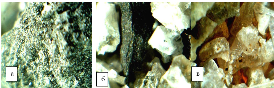
Рисунок 1. Структура активной золошлаковой смеси Ангреной ТЭС: а–общий вид; б-шлаковая часть; в-золевая часть. x100
