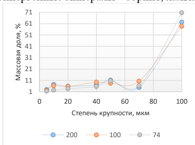
Рис. 2. Распределение халькопирита по степени раскрытия частиц
