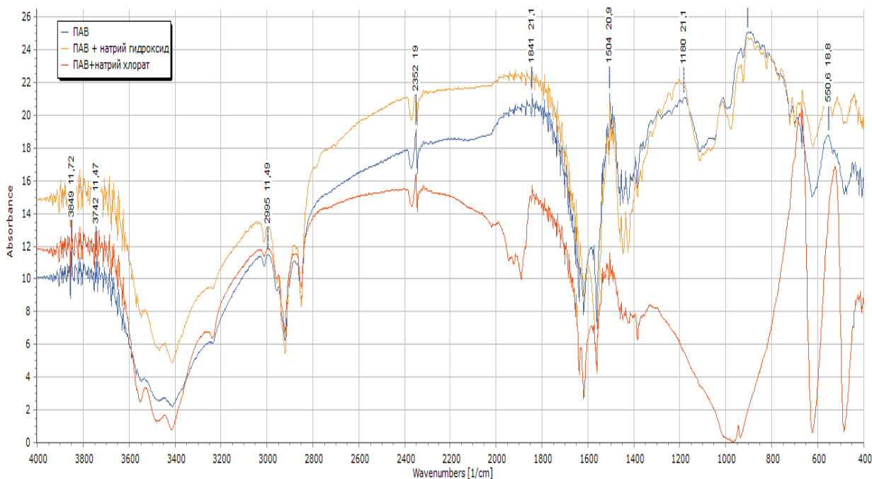
6-расм. Соапсток, NaOHли соапсток ва натрий хлоратига соапсток қўшилгандаги ИҚ спектрлари.
