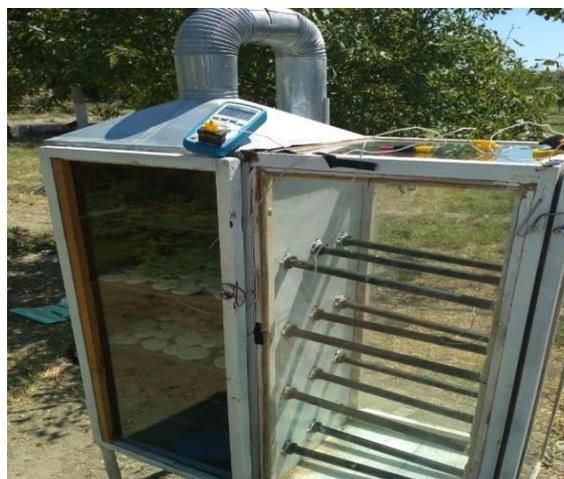
**Рис. 3. Схема лабораторной сушильной установки с использованием тепловых труб**
