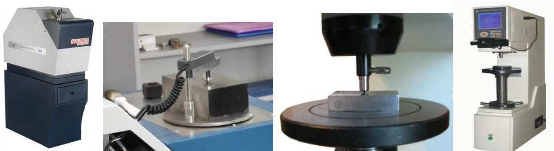
Определение химического состава с использованием а-спектрометра Solaris CCD Plus loom, б - измерение твердости - метод Роквелла.
