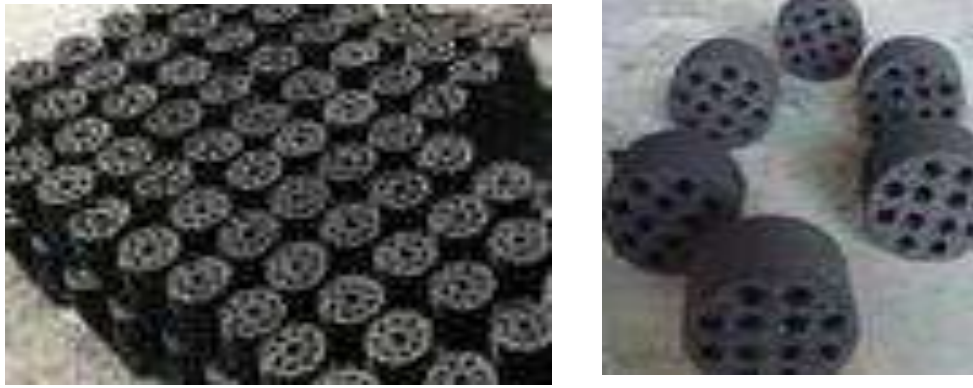
Рис. 2. Угольные брикеты на основе биоорганических связывающих
