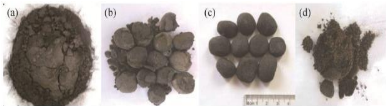
6 -расм. Турли ҳароратларда тикланган гранулаларнинг тасвирлари: (a) 600°C; (b) 800°C; (c) 900°C; (d) 1000°C.
