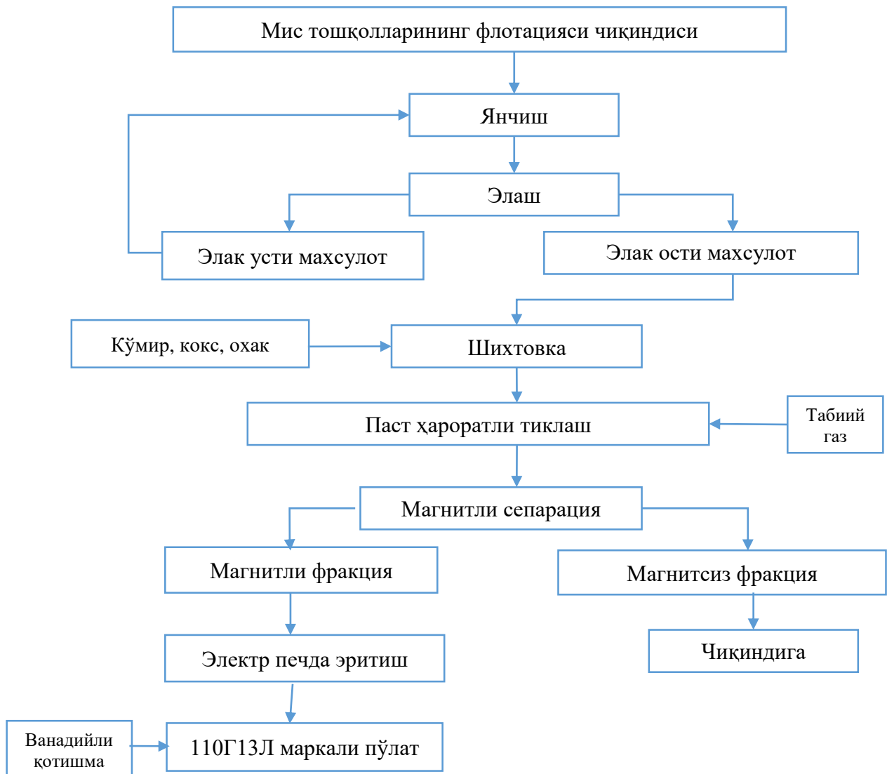
11-расм. Темирни қаттиқ фазали тиклаш йўли билан мис тошқолларининг флотацияси чиқиндиларини қайта ишлашнинг технологик схемаси
