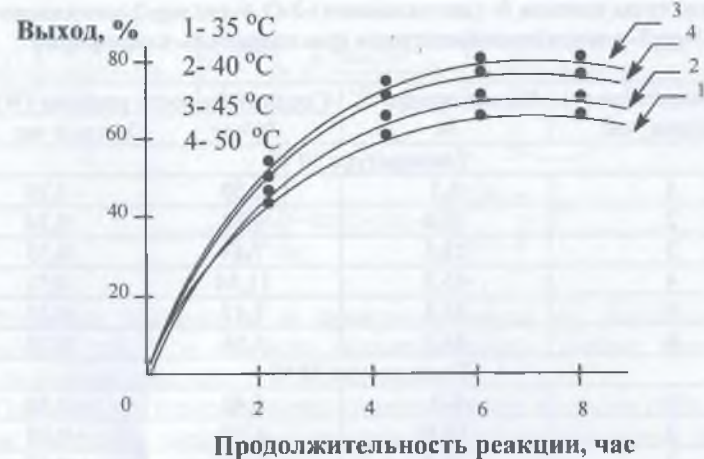
Рис. 1. Влияние температуры и продолжительности реакции на выход 5-диэтиламино-(3,4-дихлоро-2-метилпент-3-ен-2-илокси)пропаннитрила.
