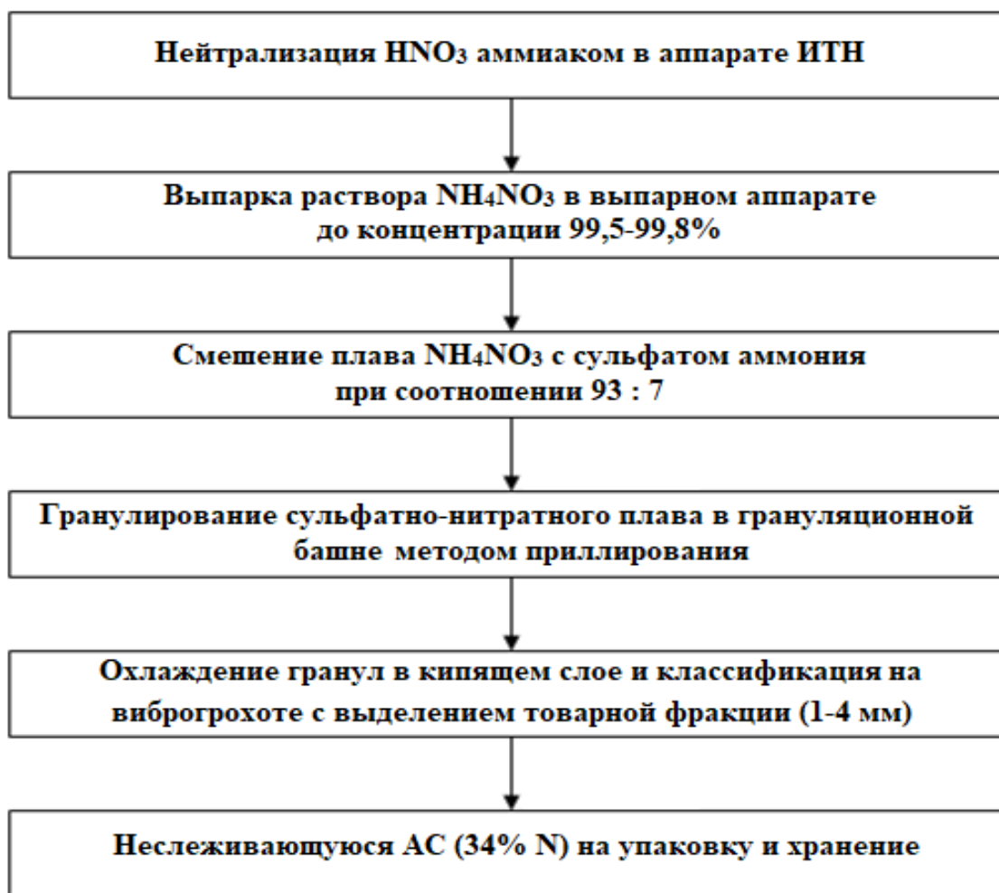
Рис. 5. Блок-схема производства неслеживающейся АС с добавкой сульфата аммония.
