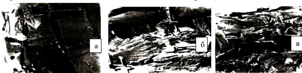
Рис.7. Микрофотографии реплик с поверхности САЖ клинкеров \times 5300 Состав: \text{KH}=0,667 и n_s=1,0 (а); 1,5 (б); 2,0 (в). T_{\text{обж}}=1200^{\circ}\text{C}
