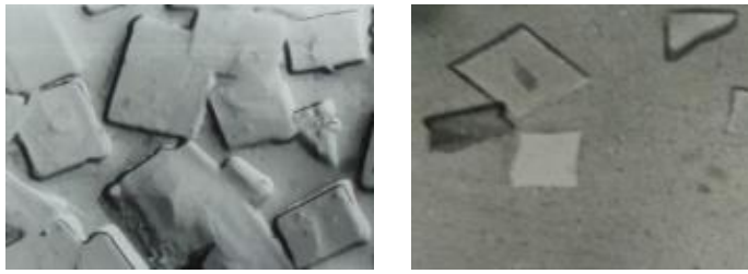
Рисунок 4. Микроструктура синтезированного образца MgAl_2O_4+(1,5\%)Eu_2O_3 (ув.7500)
