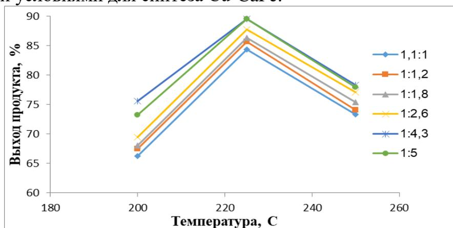
Рис. 3. Графическое представление массового отношения  $\text{CuCl}$  и  $\text{CaCl}_2$ , полученного для  $\text{Cu-CaPc}$  и влияние температуры на выход пигментов.
