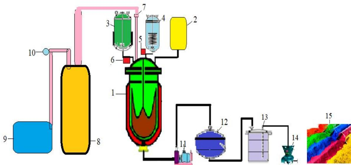
1 - реактор синтеза; 2- исходные материалы; 3-ёмкость для серной кислоты; 4 - ёмкость для горячей воды; 5 и 6 - дозаторы; 7 - патрубок отвода газа; 8 - ёмкость для фталимида, 9 - ёмкость для воды; 10 – воздушный насос; 11 - насос; 12 - фильтр закрытого типа; 13- сушильный шкаф, 14-измельчитель; 15 готовая продукция.
