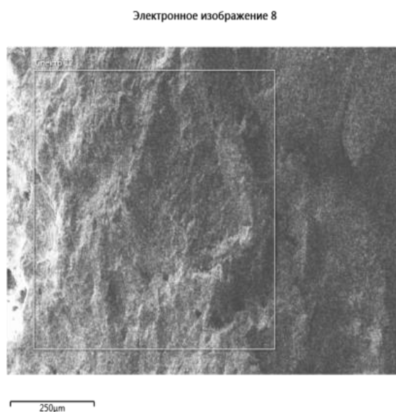
Рис. 3. СЭМ анализы серного бетона.
