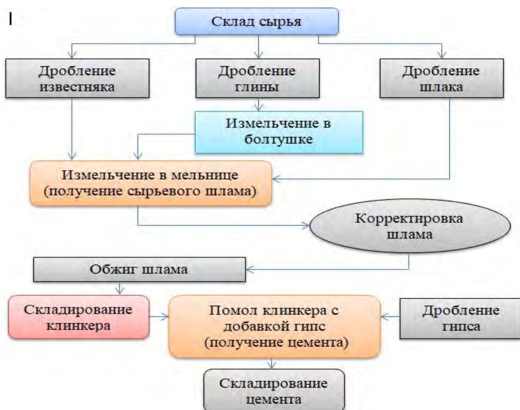
Рис.4. Технологическая схема производства портландцементного клинкера на основе Деванасайского глинистого сланца
