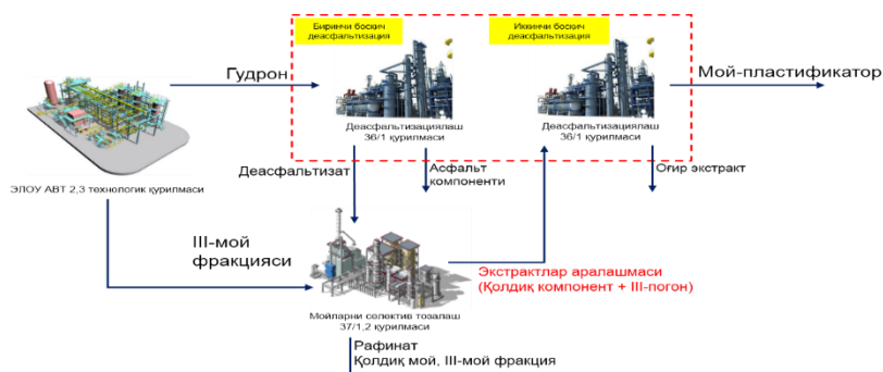
7-расм. Таклиф этилаётган мой-пластификаторни ишлаб чиқариш схемаси
