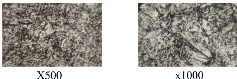
Рис.7. Микроструктуры стали У10 прошедшей полный цикл термоциклической обработки. Вторая закалка с температуры 780 °С. Окончательный отпуск 180 °С
