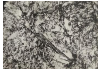
7-расм. Термоцикли термик ишлов беришнинг тўлиқ циклидан ўтган У10 маркали пўлатнинг микроструктураси Иккинчи тоблаш ҳарорати 780 °С. Якуний бўшатиш ҳарорати 180 °С.
