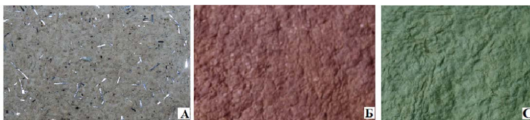
5-расм. Суяқ гулқоғоз намуналари: 1 м 2 массаси: А – 521 г; Б – 341 г; С – 344 г.
