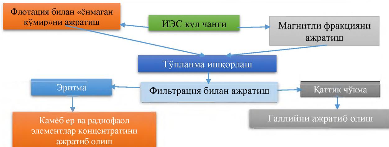
9-расм. ККЧни қайта ишлаш блок схемаси
