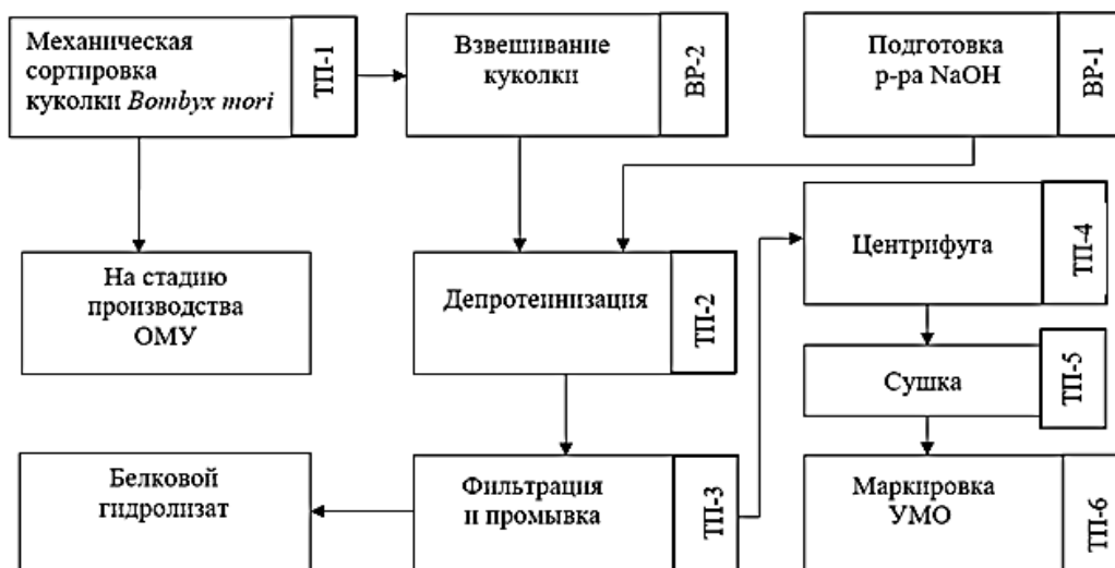
Рис.4. Схема технологии выделения хитина
