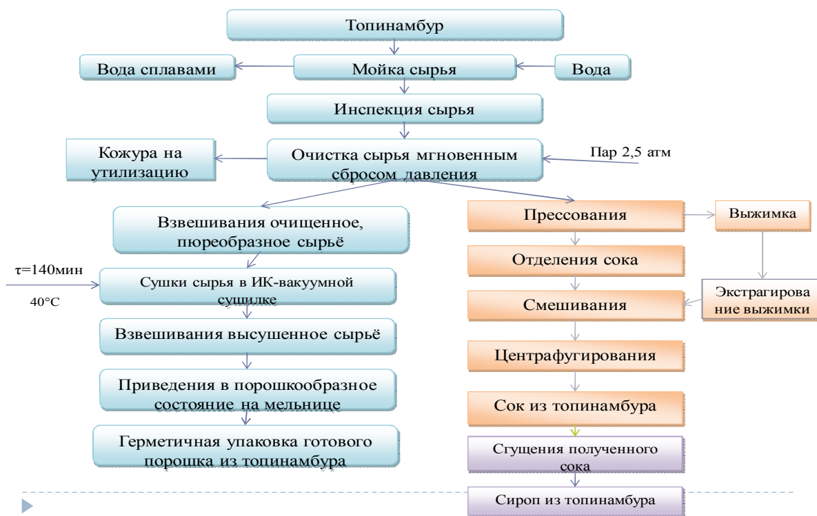
Рис 3. Принципиальная схема получения добавок из топинамбура.
