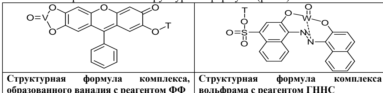
Рис. 8. Примерная структура комплексов, образованных ионами ванадия и вольфрама с реагентами ФФ и ГННС.
