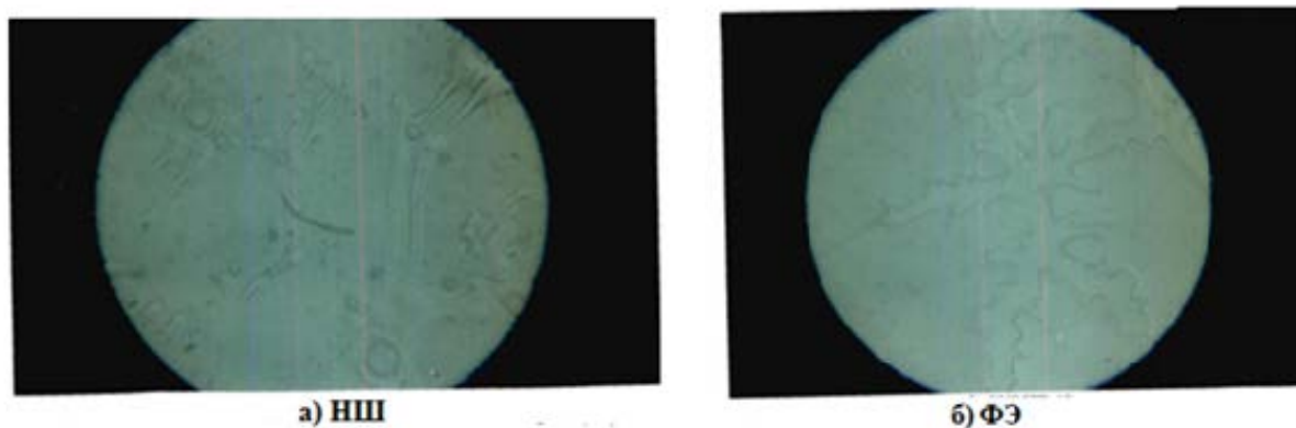
Рис.3. Оптические микрофотографии растворов нефтяных остатков в толуоле (концентрация 10%) (увеличение 125 x )
