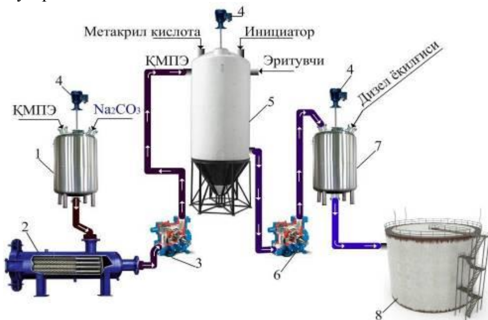
Рис. 8. Технологическая схема получения депрессорно-диспергирующей присадки на основе низкомолекулярного полиэтилена и поли(мет)акрилатов: 1 - механический смеситель для очистки; 2 - фильтр; 3,6-насосы 4 - механический смеситель; 5 - реактор, 7 - инжекторный смеситель; 8 - емкость.
