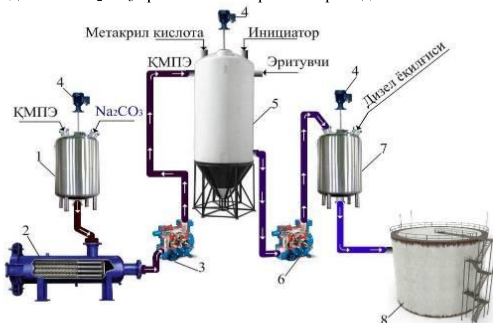
8-расм. Қуйи молекулали полиэтилен ва поли(мет)акрилатлар асосида депрессор-диспергирловчи присадка олиш технологик схемаси: 1–тозалаш учун механик аралаштиргич; 2–фильтр; 3,6–насослар 4 – механик аралаштиргич; 5 –реактор, 7 – инжекторли аралаштиргич; 8 – сиғим.
