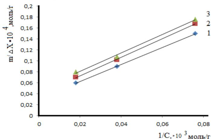
Рис. 6. Зависимость  $1/\Gamma$  от  $1/C$  для сорбции ионов хрома сорбентом при температурах 298, 308, 318 К.
