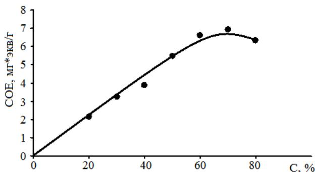
**Рис. 3. Зависимость статической обменной ёмкости П-МДА-6 от концентрации ГМДА**
