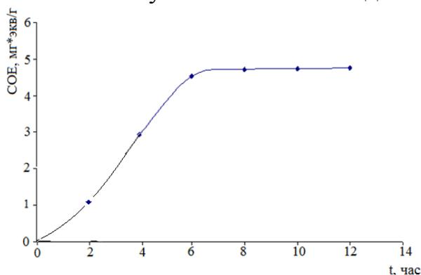
**Рис. 1. Зависимость СОЕ (по 0,1 н. НСl) полученных анионитов от продолжительности реакции при температуре реакции 433К.**
