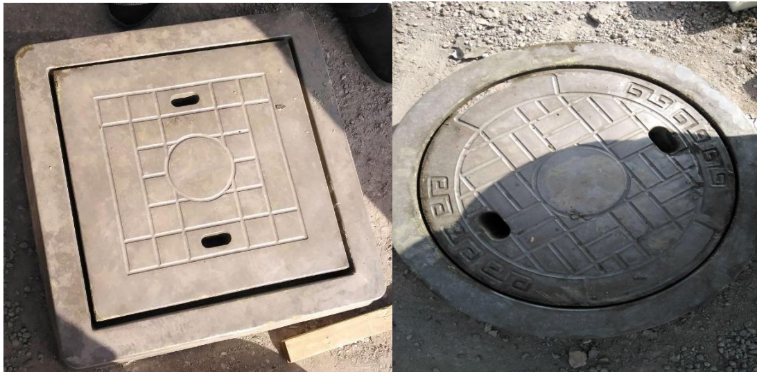
Рис. 9. Малогабаритные изделия из серобетона.
