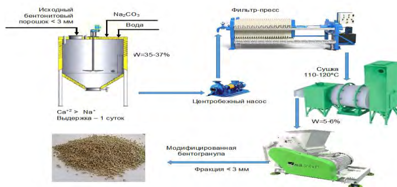
Рис.3. Технологическая схема модифицирования бентонита
