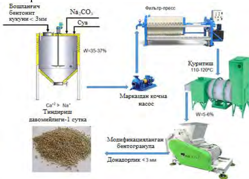
3-расм. Бентонит гилини модификациялашнинг технологик схемаси
