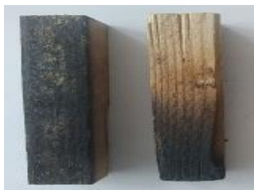
а. Конечное состояние необработанной древесины
