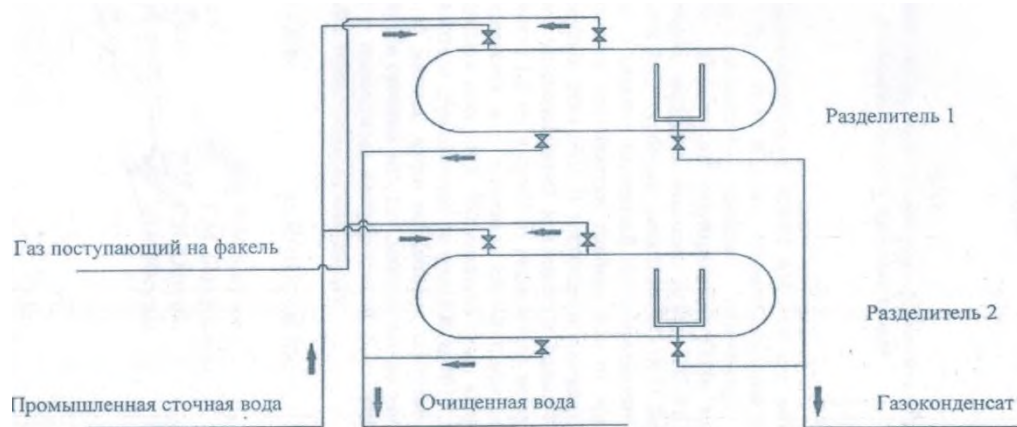
17-расм. Мубарек ГҚИЗ МЧЖ учун ишлаб чиқилган, сувдан углеводород конденсатини ажратиб берувчи, уч фазали бўлувчи қурилмасининг схемаси.
