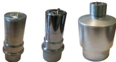
2-расм. Гамма-нурланиш детекторлаш блоклари (БДЕГ-63, БДЕГ-80, БДЕГ-150)
