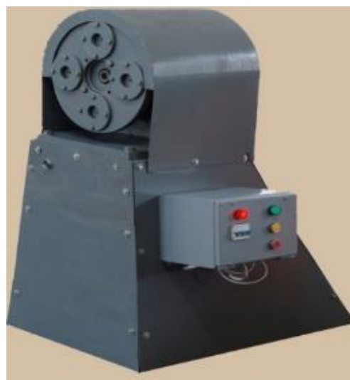
2- расм Контейнерлар тайёрлаш ускунаси А-картон трубкани кесувчи ускуна. Б-картон трубкани ёнларини тешувчи ускуна
