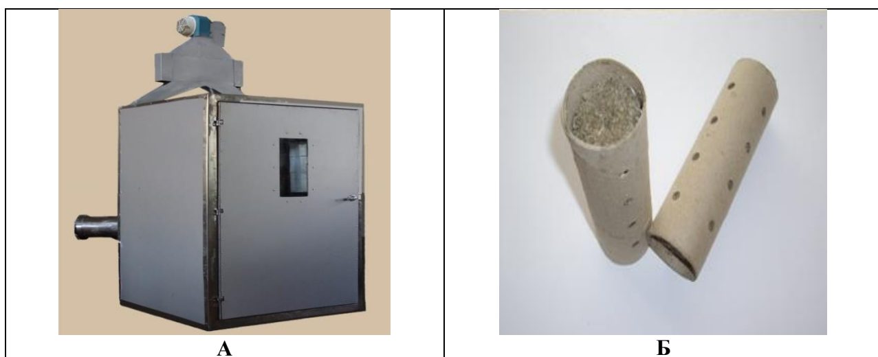
4-расм А- Заҳарли ем-хўракларни қуришиш мосламаси. Б-тайёр ем-хўрак намунаси.
