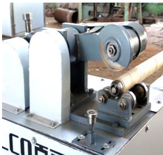
2- расм Контейнерлар тайёрлаш ускунаси А-картон трубкани кесувчи ускуна. Б-картон трубкани ёнларини тешувчи ускуна
