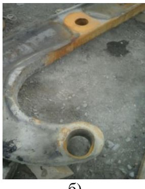
8-расм. Чўмич остки қисмини ушлаб турувчи ва очилишига хизмат қилувчи механизм ҳалқаси
