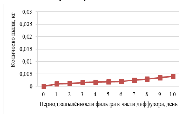
Рис. 5. Показатели количества пыли, задержанные в диффузорной части двухслойного фильтрующего устройства
