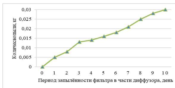
Рис. 3. Показатели количества пыли, задержанные в диффузорной части однослойного фильтрующего устройства
