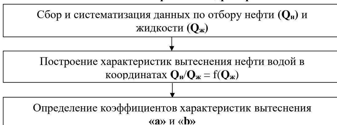
Рис.1. Алгоритм расчета дренируемых извлекаемых запасов нефти
