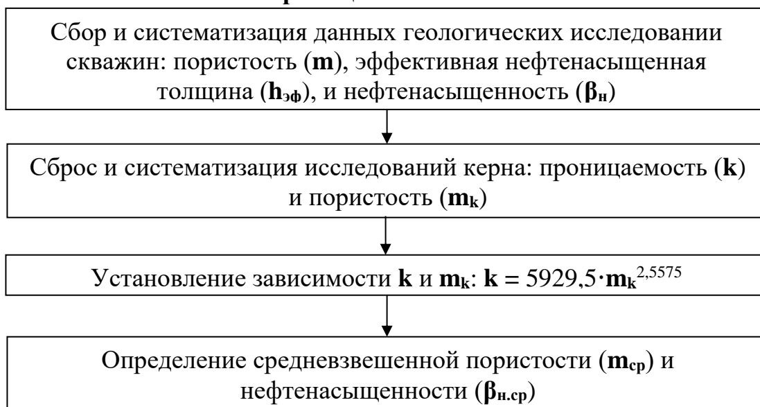
Рис.3. Алгоритм расчета среднего значения пористости, нефтенасыщенности и проницаемости
