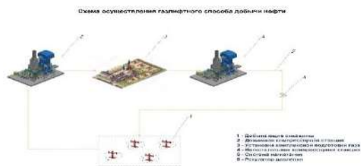
Рис. 1. Схема осуществления газлифтного способа эксплуатации 1-газодобывающие скважины; 2-компрессор; 3-система нагнетания; 4-газлифтные скважины; 5-регулятор давления; 6-газонагнетательная скважина.
