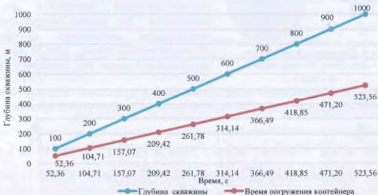
Рис.6. Графики зависимости времени погружения контейнера на глубину осложненной зоны скважины
