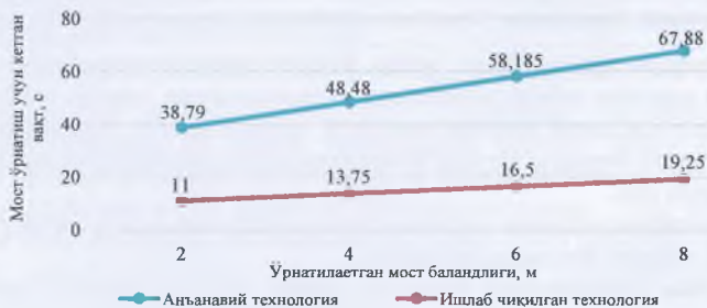
7-расм. Скважинанинг мураккаб зонасида цементли мостларни ўрнатишга сарфланган вақтлар бўйича тампонаж қоришмаларини етказиб беришнинг мавжуд ва ишлаб чиқилган технологияларини таққослама графиклари
