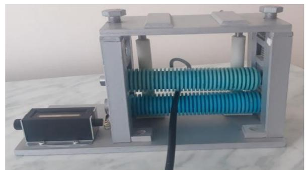
1,2 – подвижные и стационарные ролики; 3 – прижимная пружина;
