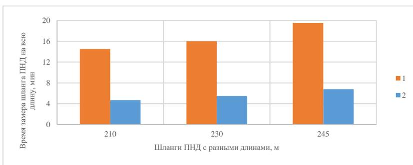
**Рис. 11. Результаты хронометражных исследований затрат времени на опытно-подготовительные работы, монтаж и демонтаж насосного агрегата**
