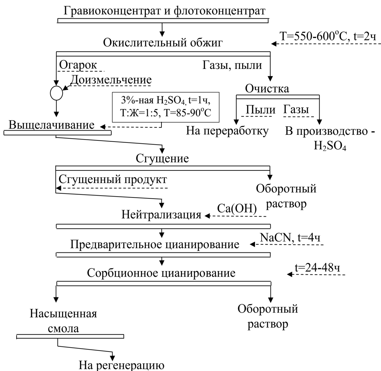
Рис. 6. Технологическая схема переработки концентрата с окислительным обжигом
