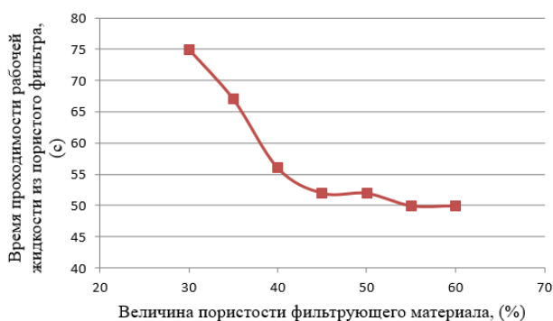
Рис. 6. Зависимость время прохождения рабочей жидкости через фильтр от количества пор материала фильтра
