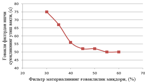
6-расм. Филтрдан ишчи суюқлик ўтиш вақтининг филтър материалнинг ғоваклилик миқдorigа боғлиқлиги
