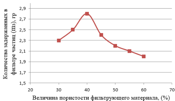
Рис. 7. Зависимость количества задержанных в фильтре частиц от количества пор материала фильтра
