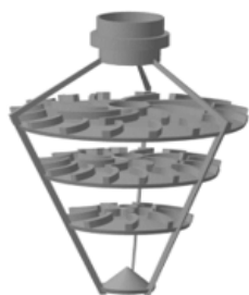
Рис. 5. Общий вид разработанной конструкции каскадной форсунки
