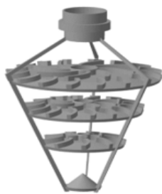
5-расм. Сув пуркагични ишлаб чиқилган конструкциясининг умумий кўриниши
