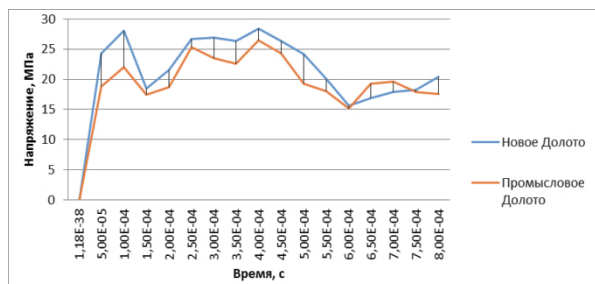
Рис. 10. Эквивалентное напряжение: серийное долото: 30кН, 100 об/мин; новое долото: 20кН, 100 об/мин
