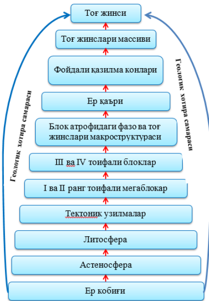
1-чизма. Тоғ жинслари массивидаги кучланишни геологик ва геодинамик шаклланиш шароити
